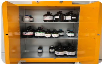
실험실 내 위험물 보관함 설치
